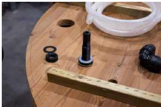
Skrue gasvarmerens indløb og returgennemføringer ind i åbningerne i bunden
