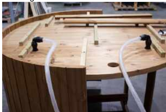
Fastgør slanger til gennemføringerne
