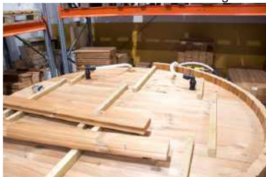
Fastgør slanger til gennemføringerne
