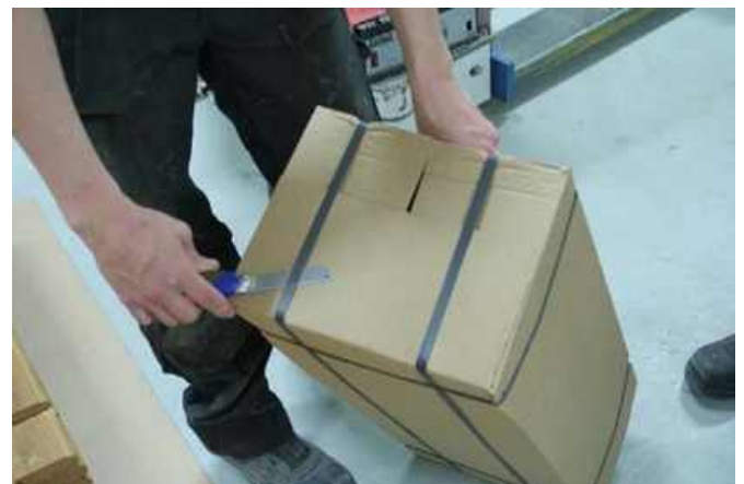
Åbn kasserne ved at skære de længere strimler, lad de andre stå, kasserne bruges som monteringsbord.
