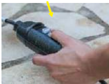
3. Tryk på knappen «TEST», indikatorlyset slukkes.
