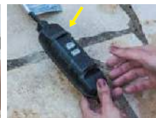
4. Tryk på knappen «RESET», indikatorlyset bliver rødt. RCD fungerer korrekt.
