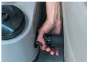
8) Tilslut pumpen til poolen ved hjælp af de 3 stik til at skru. Sørg for, at ikonerne på pumpen og poolen passer sammen
