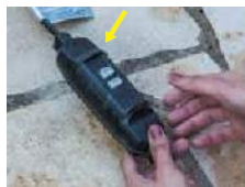
2. Tryk på knappen «RESET», indikatorlyset bliver rødt.
